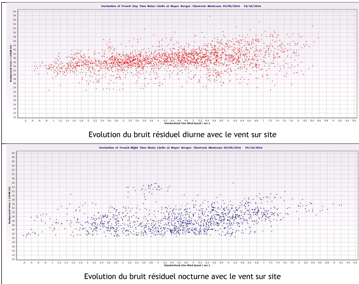
Figure 24 : Evolution du niveau sonore résiduel en fonction de la vitesse du vent sur site, pour la ZER Chevresis-Monceau, ZER Ferté Chevresis et ZER Monceau le Neuf
