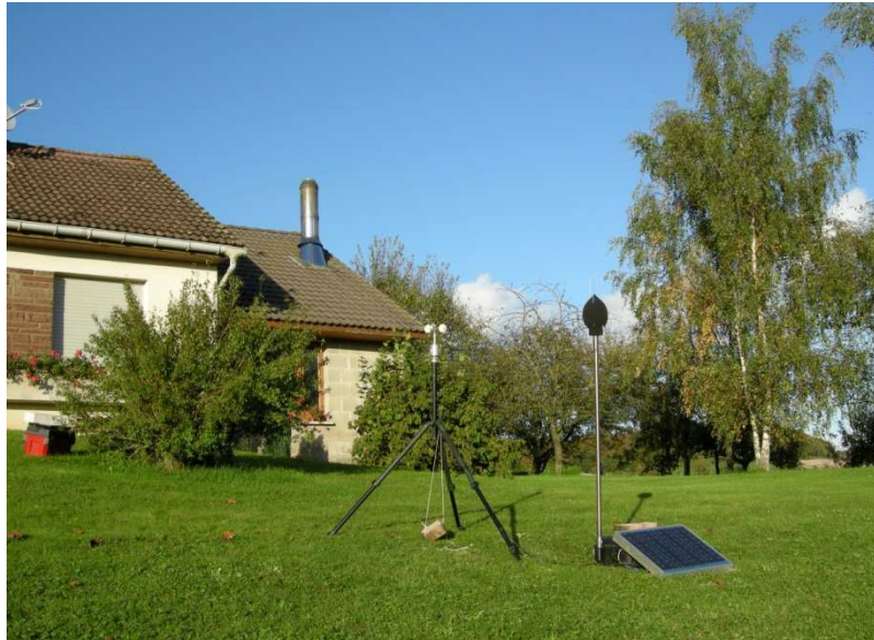
Figure 10 : Photographie d'un sonomètre en cours d'utilisation
